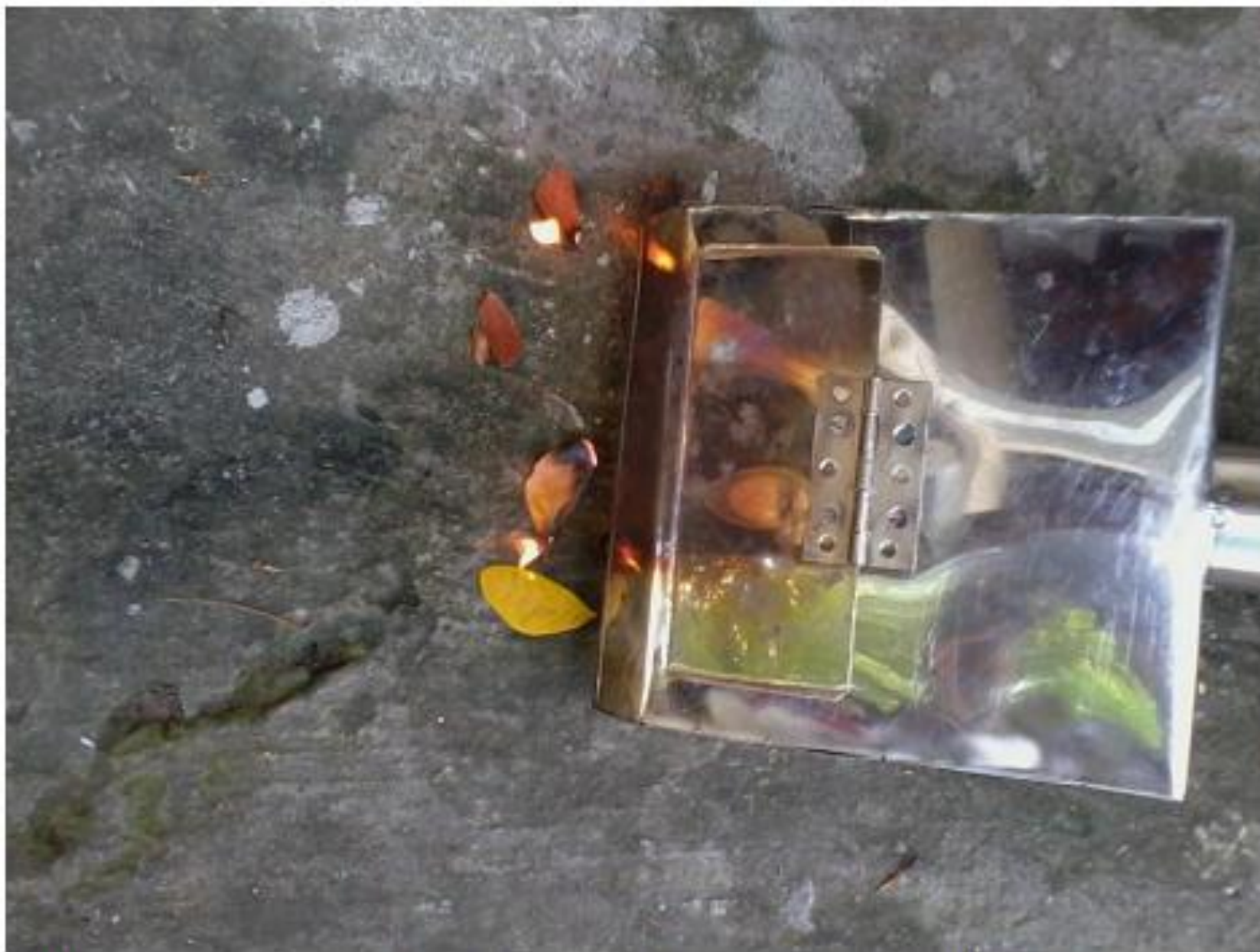
Hình dụng cụ đang hoạt động đốt rêu trên sân xi-măng làm cháy cả lá cây
